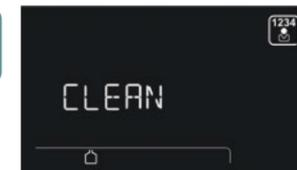
**Clean.** Funktion, die den Betrieb des Bedienfeldes während der Reinigung der Glasfläche der Bedienkonsole unterbindet, um ein unbeabsichtigtes Betätigen der Bedienelemente zu vermeiden.
