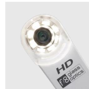
**HD-Kamera.** An der C-U2 mit Glas-Optik und LED-Diffusor ist ein 16:9 HD-Sensor integriert, der hochauflösende klinische Bilder aufnehmen kann.
