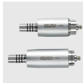
**Mikromotoren.** Zwei Versionen: i-MMr (3,3 Ncm) ohne und mit LED; i-MMs (5,3 Ncm) mit LED-Beleuchtung und Vorbereitung für endodontische Behandlungen. Beide mit 100 bis 40.000 U/min.
