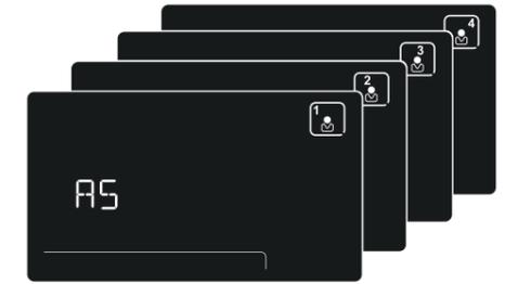
**Multiprofil.** Höchste Anwendungsvielfalt durch das Speichern von Automatismen des Mundglas-Speischalensystems, der bevorzugten Arbeitspositionen und der Einstellungen für die Verwendung der einzelnen Instrumente, für bis zu maximal 4 Benutzer. Nützliche Funktion für multiprofessionelle Praxen oder für Kliniken mit häufigem Arztwechsel.
